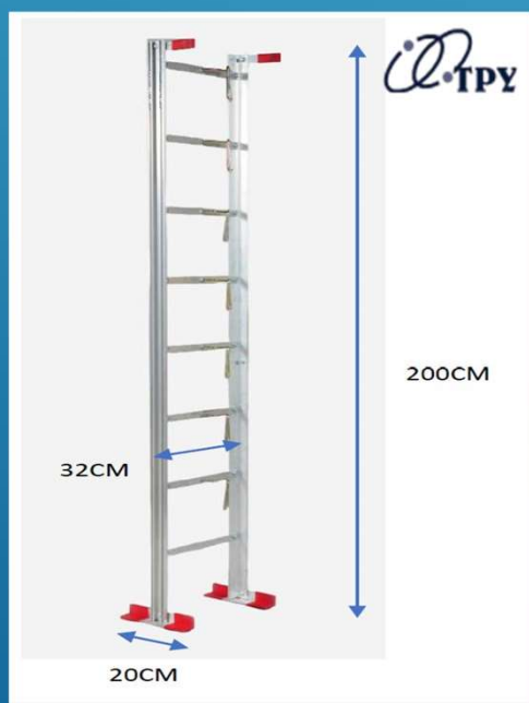
MDF配線架 100端子板或258規格共用 適用電信局機房，或大樓電線室 單雙側尺寸： 200CM(H)X20CM(w)X32CM(D)
