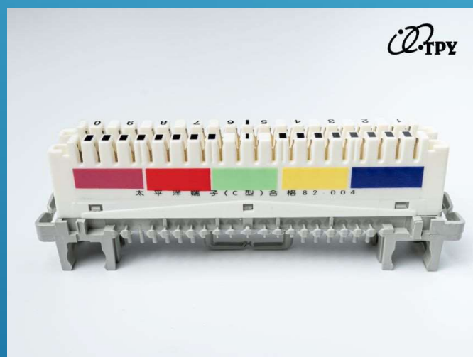
A型及C型2種 電信局審查合格82-004 材質：塑膠材質，採用ABS。金屬材質： 端子之金屬材質則是採用磷青銅鍍銀。 端子以外之金屬則是使用JIS SUS 不銹 鋼材質製造 尺寸：124 × 20 × 40 MM
